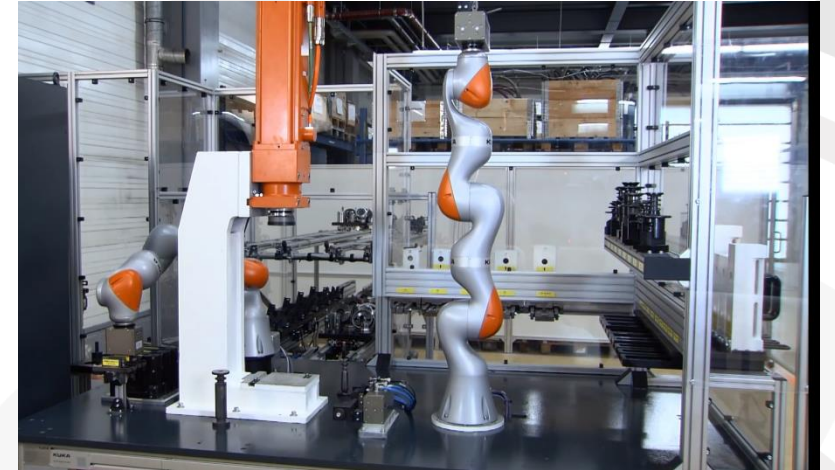
07 - Assemblage complexe - Kuka- IIWA
