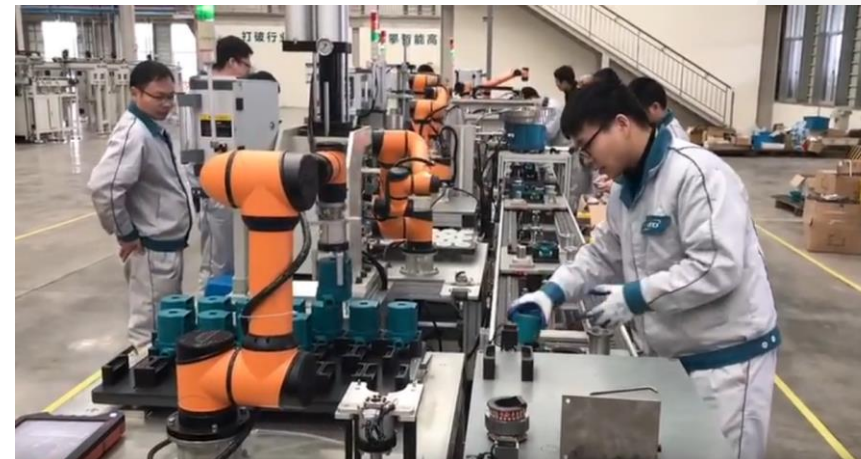
08 - AUBO Cobot Assemblage de pompes
